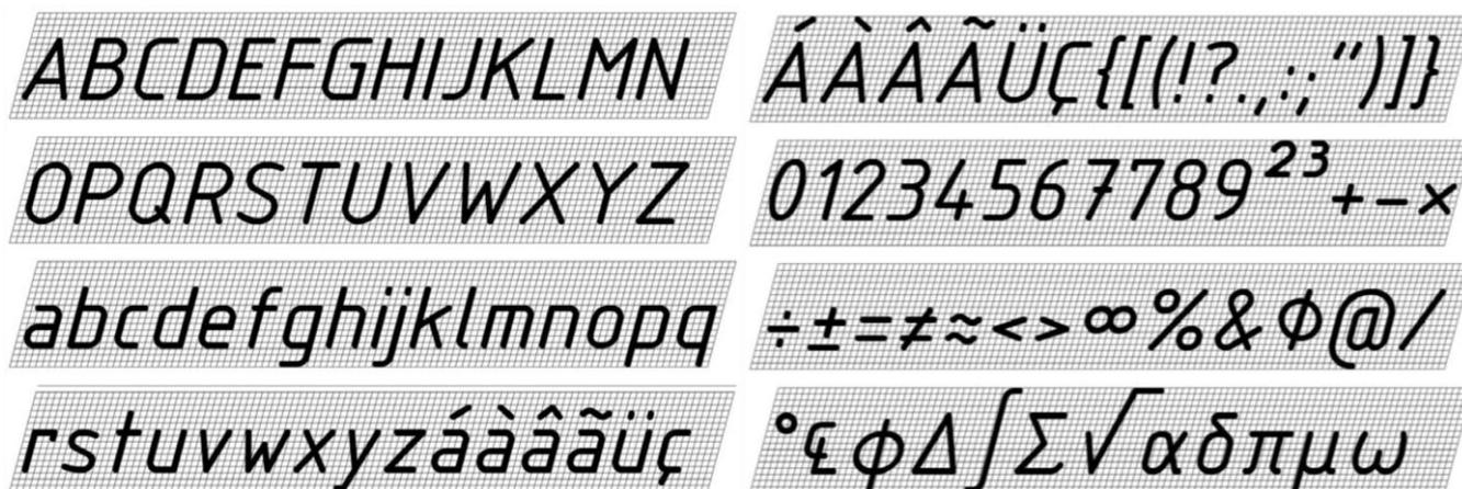
Forma da escrita inclinada com a fonte ISOCEUR. Fonte: NBR 16861 (ABNT, 2020)
