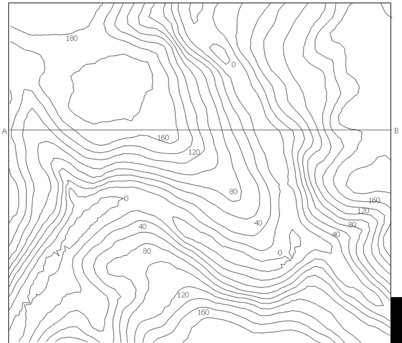
3. Representar o perfil topográfico da seção determinada pelo plano definido pelos pontos A e B.
