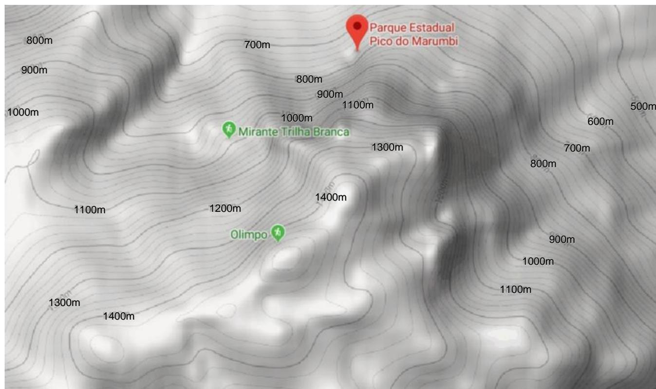
As curvas de nível são resultantes da seção plana feita por vários planos paralelos, horizontais (ou de nível) com uma superfície da terra. Nelas são indicadas as distâncias verticais acima, ou abaixo, de um plano de referência de nível. Começando no nível médio dos mares, que é a curva de nível zero, cada curva de nível tem um determinado valor. A distância vertical entre as curvas de nível é conhecida como equidistância, cujo valor é encontrado nas informações marginais da carta topográfica.
