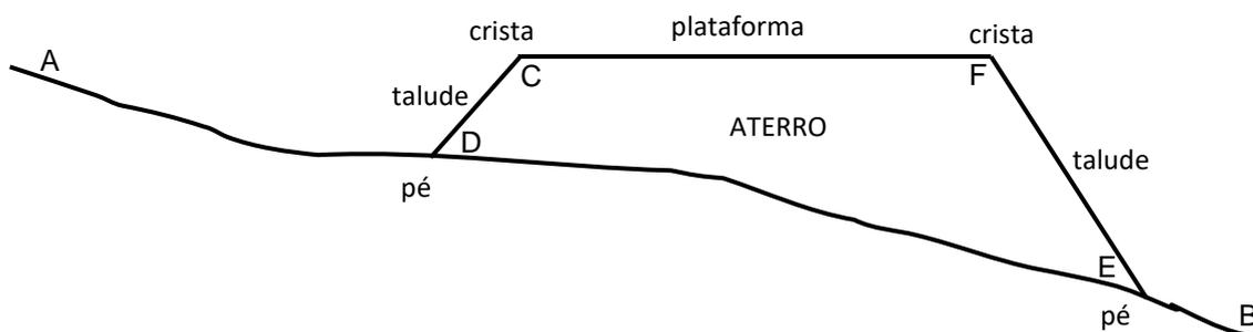
Admitindo-se que a linha AB da figura representa um perfil de um terreno, a área CDEF representa um aterro. O talude de um aterro também é chamado de **saia**. O pé de um aterro também é chamado de **offset**.
