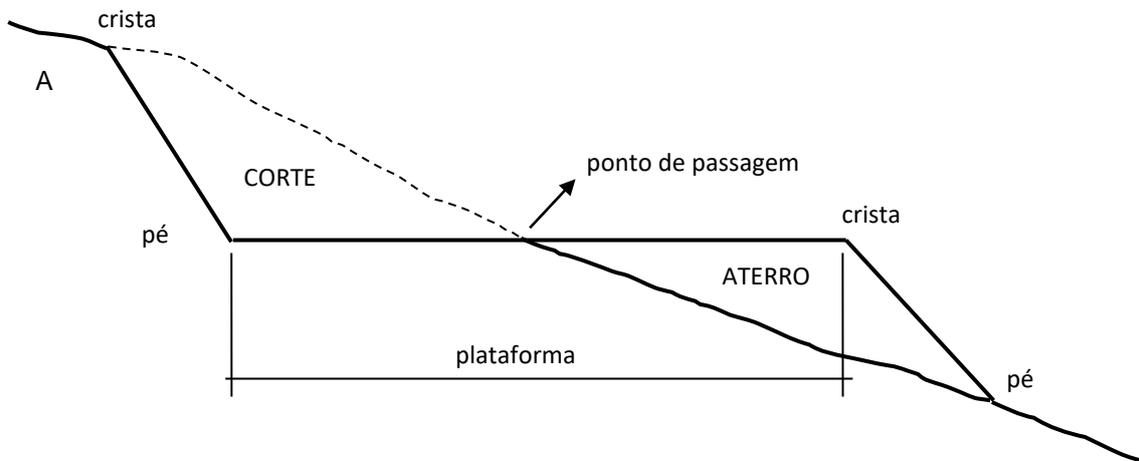
O ponto da superfície natural do terreno de mesma cota que a plataforma chama-se ponto de passagem, é nesse ponto que termina o corte e começa o aterro. A plataforma da seção mista é limitada de um lado pelo pé do corte e do outro pela crista do aterro.
