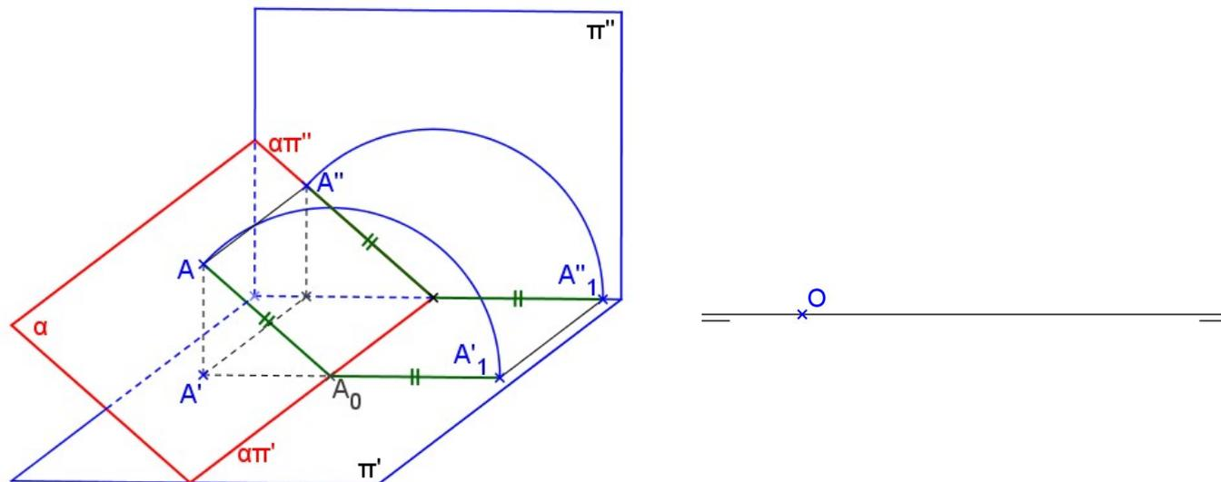
Rebatimento sobre um plano horizontal: basta considerar um plano  $\beta$  horizontal e usar  $(\alpha\beta)$  como eixo do rebatimento, ou seja, utilizar  $(\alpha\beta)'$  como se fosse  $\alpha\pi'$ .
