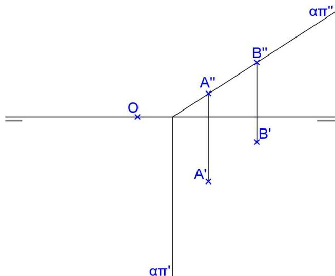
3. Representar uma pirâmide regular quadrangular V-ABCD com a base apoiada em um plano  $\alpha$  de topo que passa pela origem e forma  $45^\circ$  com  $\pi'$ , dados  $A(10,20,?)$  e  $B(30,00,?)$ ,  $h=50$ .
