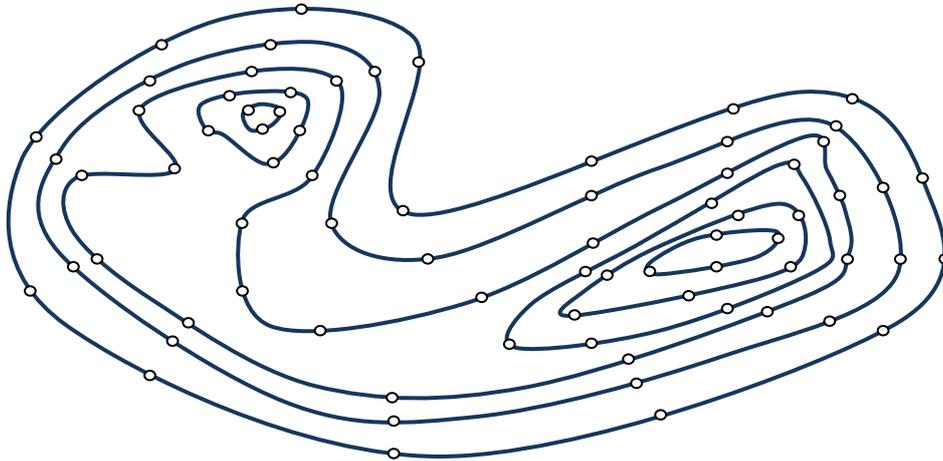
Para encontrar os pontos de cotas inteiras, utiliza-se o método da triangularização, ou seja, na malha onde será representada a planta contendo as curvas de nível, os segmentos são divididos de forma a representar os pontos de cotas inteiras. Um exemplo é apresentado na figura a seguir.
