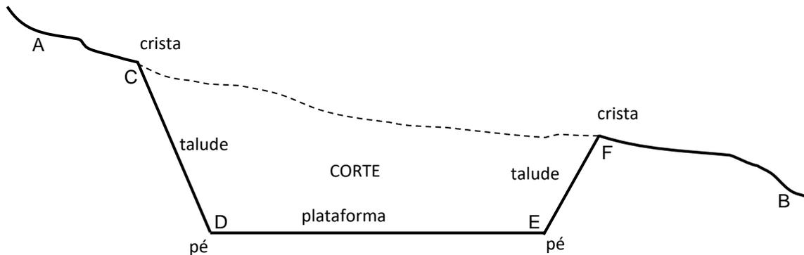
Admitindo-se que a linha AB da figura representa um perfil de um terreno, a área CDEF representa um corte. A superfície do terreno proveniente de um corte ou aterro chama-se **talude** ou **rampa**, a **crista** de um corte é chamada de **offset**.
