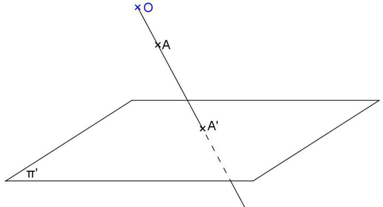
A **projeção cônica** de um ponto  $A$ , no plano  $\pi'$  a partir de  $O$ , é o traço  $A'$  produzido sobre  $\pi'$ , pela reta projetante do ponto  $A$ .
