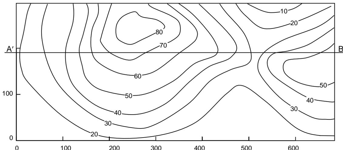
Considere que a superfície topográfica tenha seu corte pelo plano frontal representado nos eixos cartesianos  $x$  e  $z$ .
